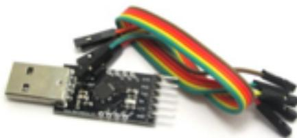
USB zu TTL-Konverter-Modul mit eingebautem in CP2102
